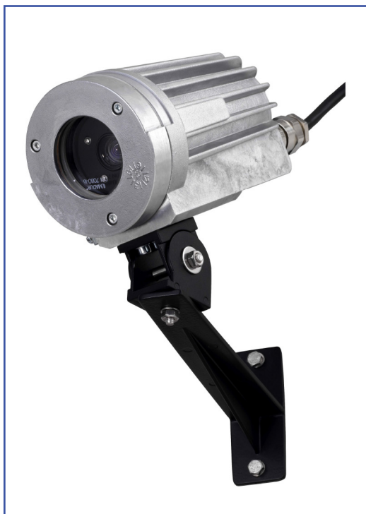
Ex kamera typ Vario, uložení ze slitiny hliníku Ex d IIC T6, Ex tD A21 IP67 T80 °C, Ex II 2 G + D, se systémem pro montáž na zeď.
