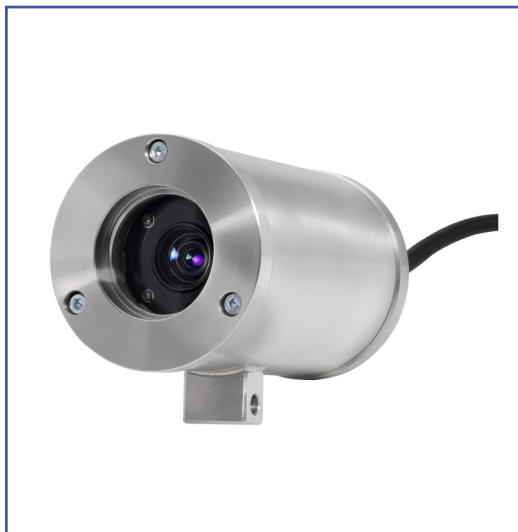
Ex kamera typ Vario, nerezové uložení Ex d IIB T6, Ex tD A21 IP67 T80 °C, Ex II 2 G + D.
