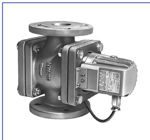
Potravní průhledítko, typ FDE 50, s osvětlením FKEL 5 dH WM, Ex d IIC T6, Ex tD A21 IP65 T80°C, Ex II 2 G+D, 230V, 5W.
