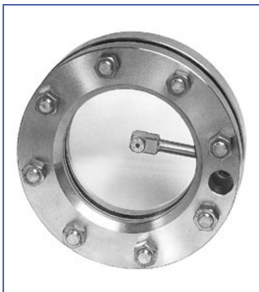
Ostříkovací jednotka, typ SV 4, zabudovaná do průhledítka dle DIN 28 120, DN 125, PN 6
