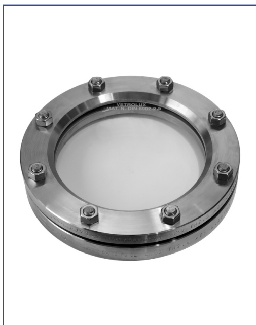
Přírubové průhledítko podobné DIN 28120, DN 150, PN 2,5, se sklem dle DIN 8902.
