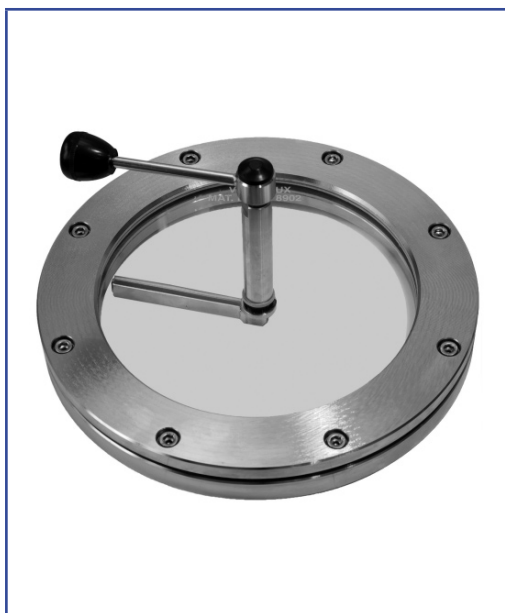
Přírubové průhledítko podobné DIN 28120, DN 150, PN 0 se sklem dle DIN 8902 a stěračem typ W (silikonová lopatka).
