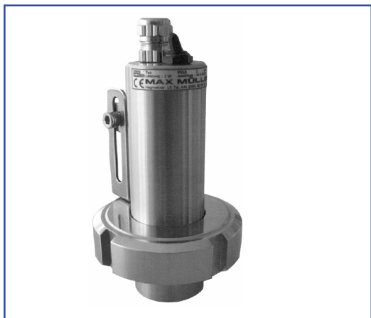
Micro LED osvětlení, MVL R 2 LED E Sch1, 2 W, 24 V AC/DC, se zabudovaným tlačítkem zapni/vypni „E“, namontováno na maticové průhledítko podobné DIN 11851, DN 32, PN 6
