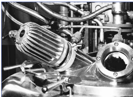
Osvětlení CHEMLUX®, typ L 20 dH Sch, 20 W, 230 V, Ex de IIC T5, Ex tD A21 IP 65 T95°C, Ex II 2 G+D, s upevněním Sch na bubnové odstředivce
